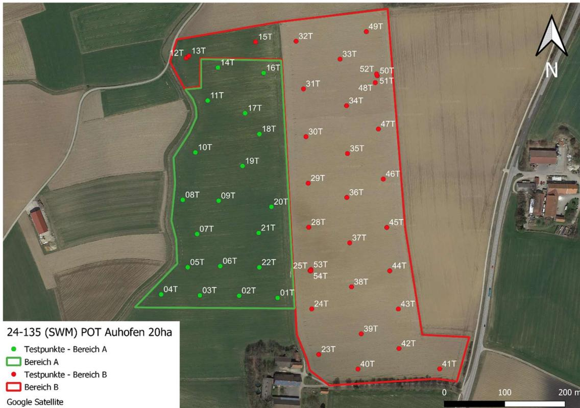
**Abbildung 3** – Getesteter Bereich, Testpunkte und Abgrenzung der Tragfähigkeitsbereiche
